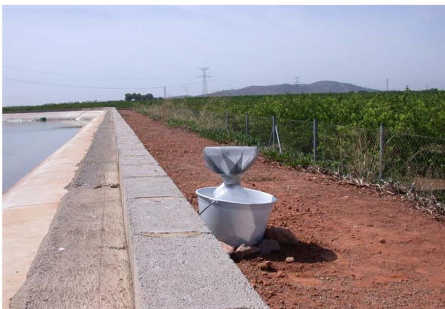
Figura 2.4. Dispositivo de muestreo de agua de lluvia en el embalse de Unión Agrícola
