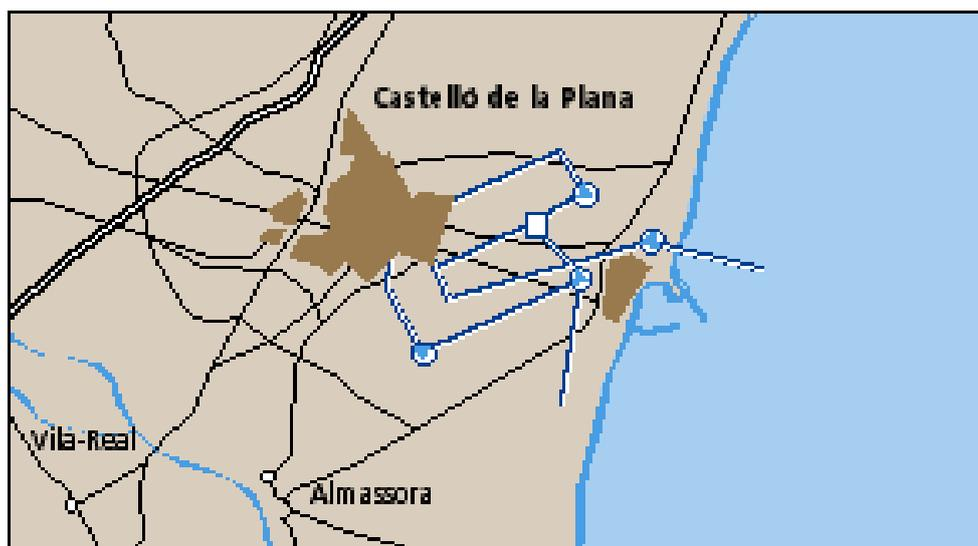
*Figura 6.12. Colectores y emisario de la E.D.A.R. de Castellón de la Plana.*
